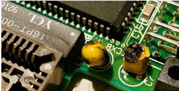
動作不良の原因は電源ラインに入ったタンタルコンデンサが破裂していたから。新しいのを買って取り替えてからSE/30に挿し直すと起動して、ちゃんと認識された。
